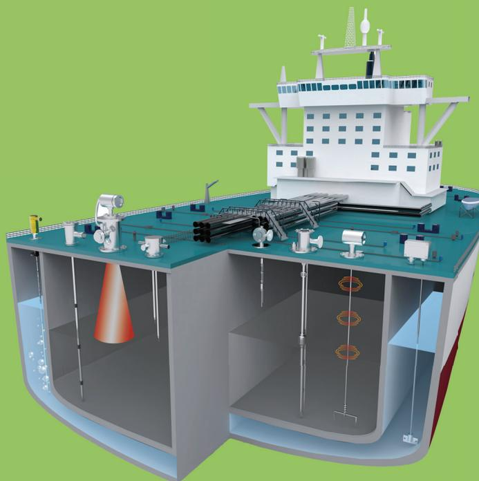
パナシアの水位制御・計測装置は海水、燃料、原油、ケミカルを正確に計測します。この計測値はリアルタイムでの表示され、設定されたアラーム機能で船舶の安全と海洋汚染防止に活躍しています。
